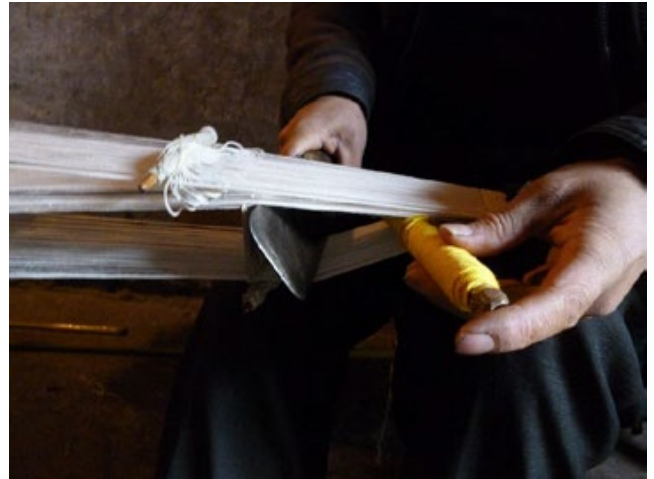
写真-44 平織部分の下口開口部分に環状にヨコ糸を入れる様子
