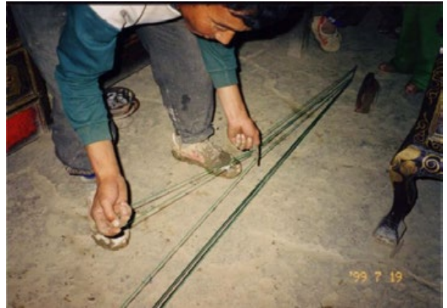
写真-20 土間に打ち込んだ釘の間で整経する
