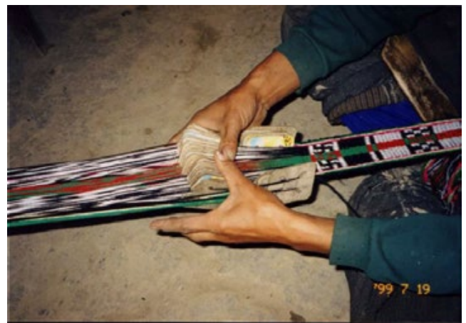
写真-24 耳がタテもじり織組織、文様はタテ二重組織の製織の様子
