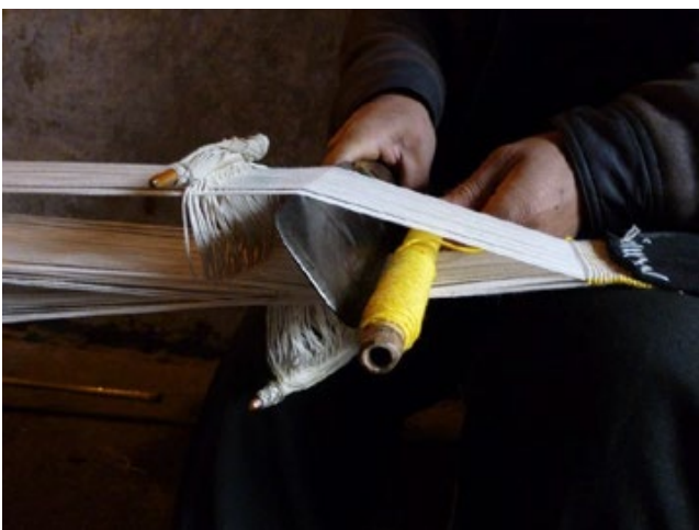
写真-43 平織部分の上口開口にヨコ糸を入れる
