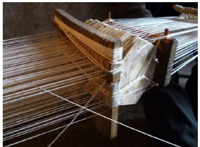
写真-45 平織時、カードにタテ糸が通っているが、使用しない（写真の右側が織前）
