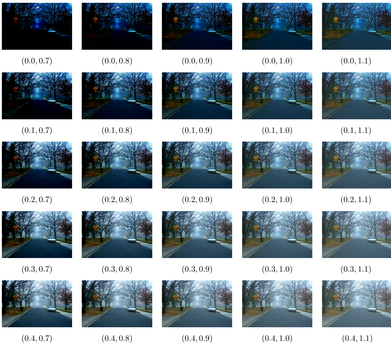
図 4.15 提案手法による road のヘイズ除去処理結果 (括弧内の値は (\alpha, \beta) を意味する)
