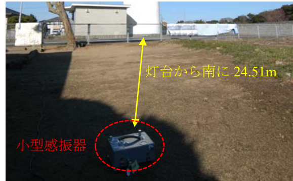
図 5-4 鹿嶋灯台の地盤の常時微動測定における小型換振器の設置状況
