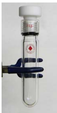
図6-4 耐熱-耐圧ガラス容器
